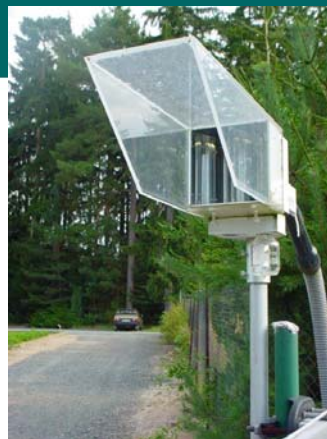
Vzorkovač mlhy (malé povodí Lesní potok, Voděradské bučiny)
