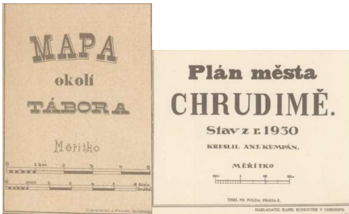
Obr. č. 3 a 4 Ukázka grafických měřítek z map: Mapa okolí Tábora. Vypracoval J. Hemmr. Měřítka 1:76 000. 6,6 cm = 5 km. Tábor: Václav Kraus, [mezi 1900 a 1920?] a Plán města Chrudimě: stav z r. 1930. Kreslil Ant. Kumpán. Měřítka 1:6 400. 4,7 cm = 300 m. V Chrudimi: Karel Kohoutek, 1930. (© Univerzita Karlova v Praze, Přírodovědecká fakulta, Mapová sbírka.)
