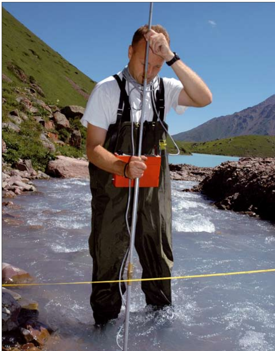
Měření průtoku vody pomocí hydrometrické vrtule. Průtok vody v daném místě je cca 1 m^3/s .
