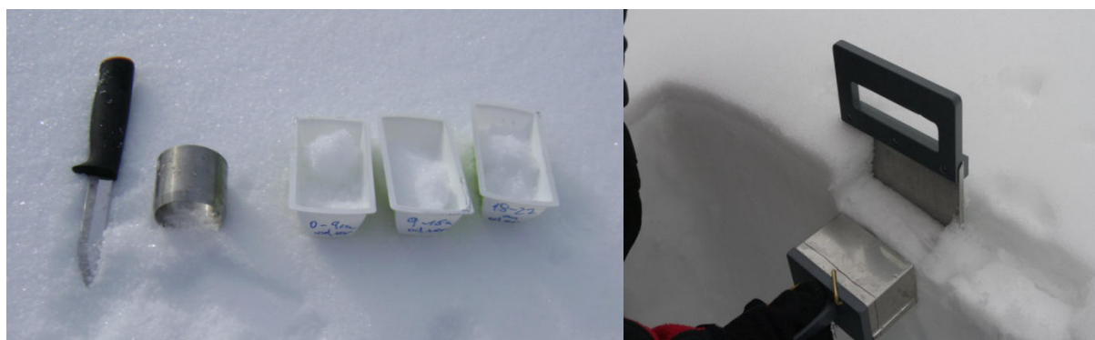
Obr. 4 Pomůcky pro odběr izotopového profilu. Kopeckého válečky (vlevo) a speciálně navržený odběrák (vpravo)
