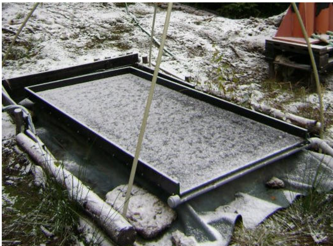
Obr. 5 Váhový sněhoměr na lokalitě Uhlířská - Tomšovka, ČVUT v Praze
