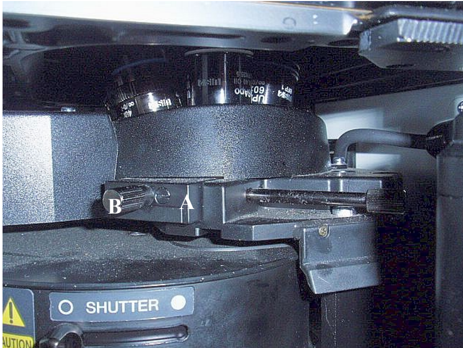
Olympus 4: A) Zásuvný Wollastonův hranol B) Šroub pro seřízení polohy hranolu
