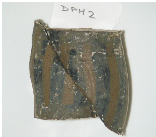
Obr. 1. Vzorek OCR=2 po zkoušce, jasně zřetelná je lokalizace deformace ve smykové zóně
