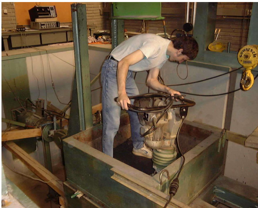
Obr. 54: Hutnění vzorku vibračním pěchem
