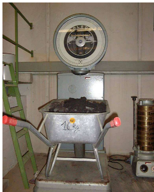
Obr. 55: Vážení materiálu před vsypáním do smykové krabice
