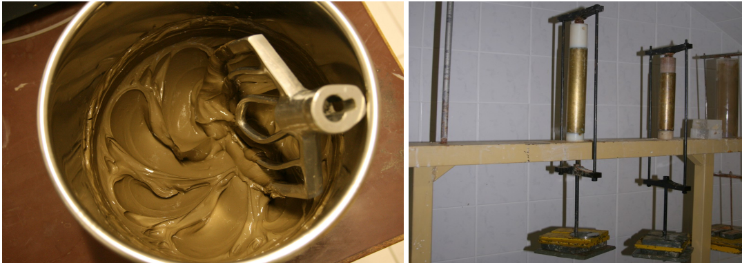
Obr. 2: Příprava rekonstituovaných vzorků pro trojosou zkoušku
