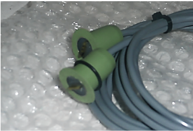
Obr. 2 Bender elementy používané na Přírodovědecké fakultě UK pro měření horizontální smykové tuhosti vzorku.
